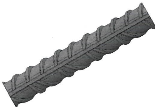
Fig. 1 - Oțel beton B500B și B500C Profil cu nervuri având unghiuri alternante de înclinare față de axul barei
